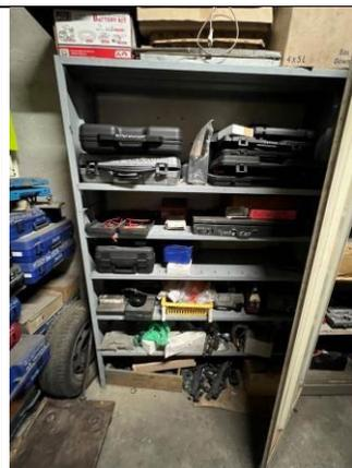
Armoire contenant du matériel pour véhicules électrique (VAT, MIDTRONICS, outillages, nappes et housses de protection, bacs de rétention, testeur de tensions, chargeur embarqué, protections diverses (casquette isolante, visières, gants ...)
