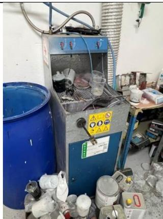
Machine de nettoyage pour pistolets de peinture
