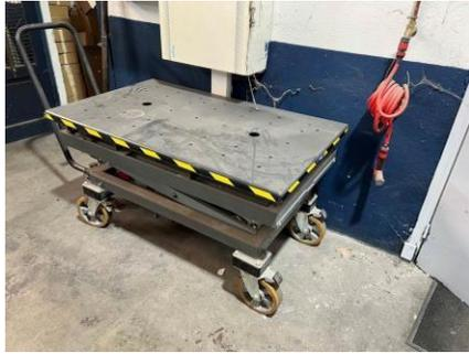
Table de levage bacs batteries véhicules électriques BLITZ
