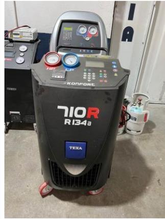
Station de recharge ou de maintenance de circuit de climatisation TEXA 710R R134a
