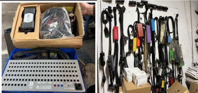
Interface de communication, (recherches de pannes sur faisceaux électriques) PEUGEOT CONNECT 129 S.1251 + lot de cordons véhicules anciens
