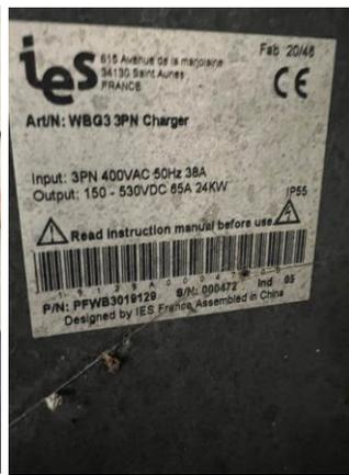
Borne de recharge rapide pour véhicules électriques IES
