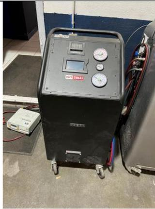
Station de recharge de climatisation ISOTECH gaz 1234 yf (nouveau gaz) avec recharge
