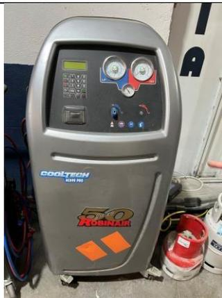
Station de recharge de climatisation ROBINAIR COOLTECH AC690 PRO avec recharge
